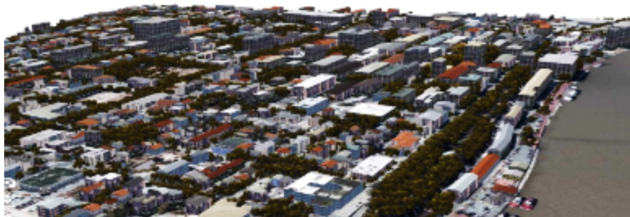
Fig.1 : Maquette procédurale de la ville de Savannah, Géorgie, États-Unis, extrudée à partir des données LiDAR (polygones et points). Spatialisation faite dans Arc MAP et extrusion dans City Engine, Environmental System Research Institute (ESRI). Source : Christine Wacta.
