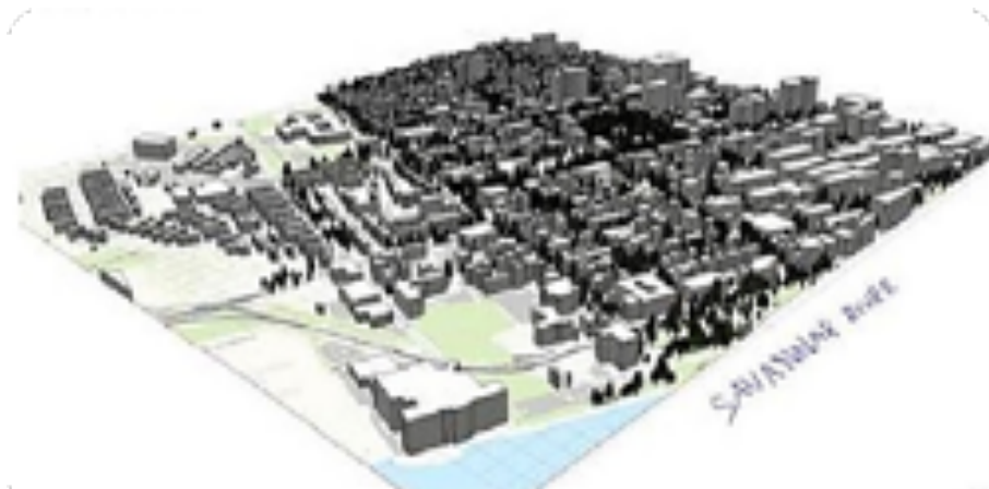
Fig.3 : Maquette de ville procédurale illustrant les masses sans rendu du matériau. C'est une étape utile permettant une visualisation rapide des hauteurs. Réalisée avec City Engine, (ESRI). Source : Christine Wacta.
